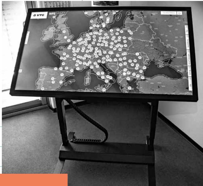
Der VTG Fleet Table ist eine Touchscreen-basierte Lösung für Flottenmanager, die es ihnen erleichtert, Wagen effizient zu überwachen, zu steuern und die Instandhaltung zu planen.
