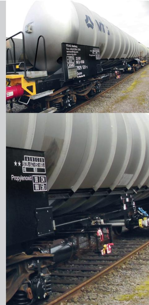
Gewichtsoptimierter spezieller Chemikesselwagen aus Edelstahl mit Druckgasausführung (Flüssigphase & Gasphase) für den Transport von z. B. Propylenoxid.
