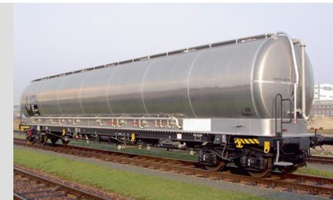
Optimiert für den Transport von Braunkohlenstaub (Gefahrgut) und Staubgütern mit einer Schüttdichte von ca. 0,5 t/m<sup>3</sup>.
