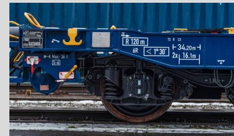
Der multifunktionale Doppel-Taschenwagen ist für den Betrieb auf der iberischen Halbinsel (ES, PT) konzipiert. Mit einer Taschenbreite von 2.700 mm und einem erweiterten Hüllraum ist der Taschenwagen besonders für den Transport von (Mega-)Trailern bis 15.100 mm Länge geeignet. Ein höhenverstellbarer Stützbock erlaubt die effiziente Be- und Entladung.
